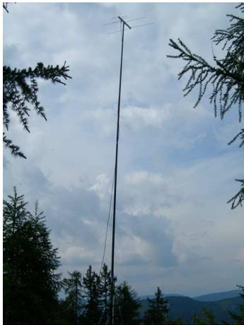
IN3HEZ monta la HB9 per i 144Mhz sulla canna da pesca a 7mt d'altezza e inizia subito a fare chiamate in 144.300 con il suo ft817 e il linearotto da 50w. Io intanto traffico un po' per accordare la verticale sui 14Mhz con il balun 4:1 e l'FT857d.
